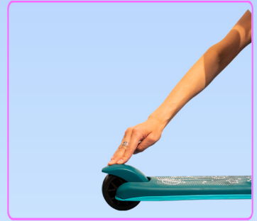
FRENO DE EMERGENCIA EN LA PARTE TRASERA DEL SCOOTER
